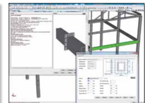
Dimensionamento di un giunto flangiato per sezione rettangolare cava; disponibile anche per sezione circolare.
