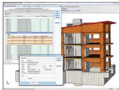
La banca dei pannelli XLam include i cataloghi dei pannelli di una vasta gamma di produttori, nazionali ed europei, incluse anche le loro specifiche certificazioni ETA.
