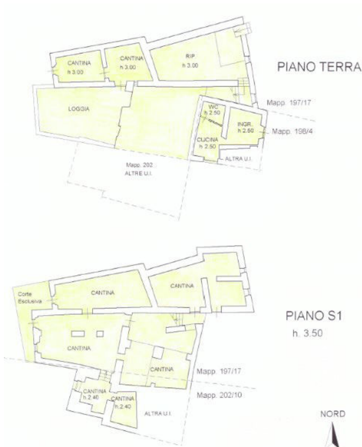
Fig. 29 - Planimetrie catastali di una unità strutturale
